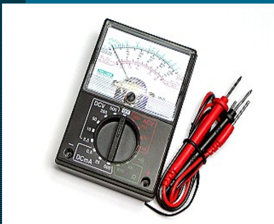
三用電表VAC檔 量測電壓
