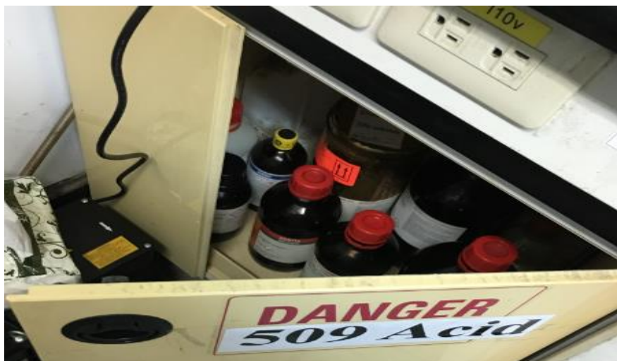
抽氣罩下酸性化學品貯存區櫃外未放置 危害物質清單
