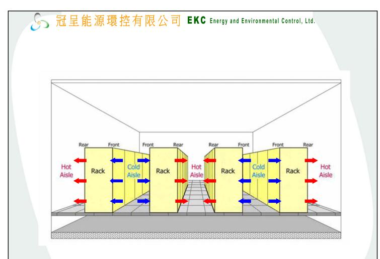
Figure 2 Het siele / cold siele cooling principle
